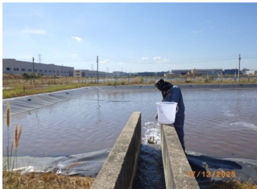
ภาพที่ 3-3 การเก็บตัวอย่างคุณภาพน้ำระบบบำบัดน้ำเสียส่วนกลาง บริเวณบ่อตรวจสอบคุณภาพน้ำ (Effluent)
