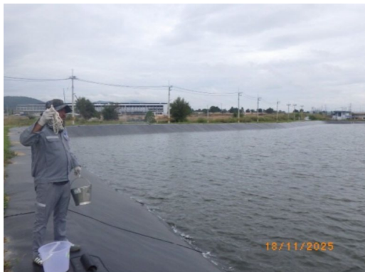
ภาพที่ 3-4 การเก็บตัวอย่างคุณภาพน้ำระบบบำบัดน้ำเสียส่วนกลาง บริเวณบ่อเก็บน้ำทิ้งหลังผ่านการบำบัด (Holding Pond)
